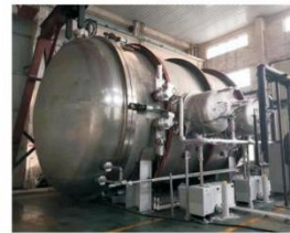
Ultra High Vacuum System 超真空系统
